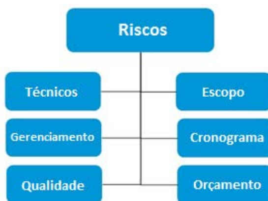
Gráfico III.2. Exemplo de uma estrutura analítica dos riscos - EAR
